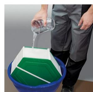
6. Bereiten Sie eine geeignete Seifenlösung vor und tragen Sie sie mit einem Messbecher von allen offenen Seiten auf den Arbeitsbereich (Plattenstapel, Kern) auf.
