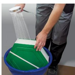
5. Legen Sie das Gerät wieder in den gereinigten Behälter und spülen Sie den Arbeitsraum (Plattenstapel, Kern) von allen offenen Seiten mit fließendem Wasser ab.
