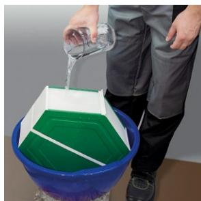
3. Tragen Sie das Desinfektionsmittel mit einem Niederdrucksprühner (Spritzpistole) oder einem Messbecher auf jede offene Seite des Arbeitsbereichs (Plattenstapel, Kern) auf und stellen Sie sicher, dass das Desinfektionsmittel über die gesamte Oberfläche verteilt wird. Lassen Sie das Gerät einige Minuten einwirken, damit das Desinfektionsmittel wirken kann.
