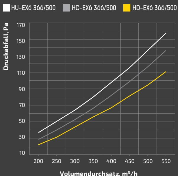
Testergebnisse an den Modell HU/HC/HD-EX6 366/500-1 mit einer Tiefe von 500 mm, Testbedingungen nach DIN EN 13141-7 (sowie EN 308)
