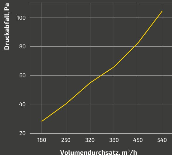
Testergebnisse an den Modell HU-EX6 271/500-1 mit einer Tiefe von 500 mm, Testbedingungen nach DIN EN 13141-7 (sowie EN 308)
