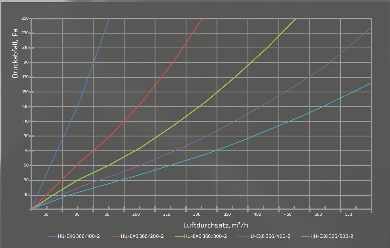
Die Ergebnisse am Modell HU-EX 366/100...500-2 mit einer Tiefe von 100...500 mm, Prüfbedingungen nach DIN EN 13141-7 (sowie EN 308)
